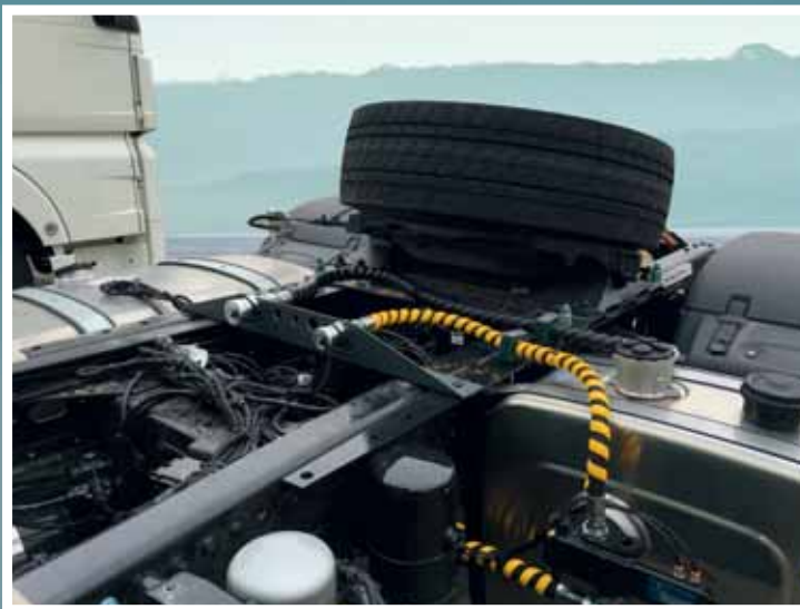
Монтажный кронштейн для быстроразъемных соединений
